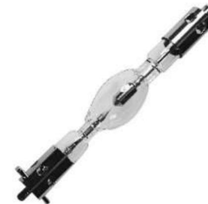
球形氙灯(又称短弧氙灯)是一种具有极高亮度的点光源,色温为6000K左右,光色接近太阳光,是目前气体放电灯中显色性较好的一种光源,被广泛地用于电影放映、民用探照、火车车头以及模拟日光等领域。
